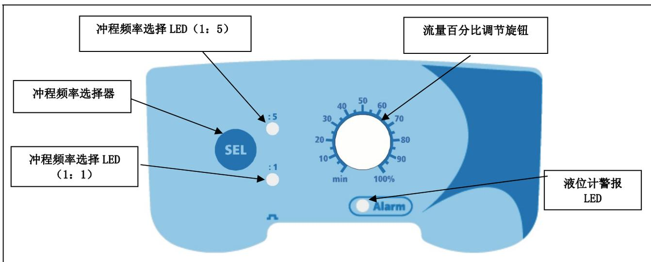
通过调节泵前部的频率调节旋钮（即：流量百分比调节按钮）可以实现对流量的调节。
