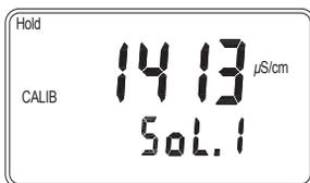
利用 **▲** 配合 **▶** 鍵輸入已知溶液之種類。此為1413 $\mu$ S標準液校正畫面。**ENTER**鍵確認之。
