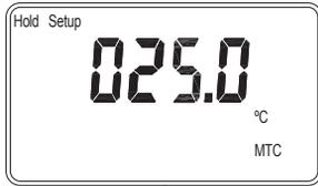
利用標準溫度計測得實際溶液溫度值，按▲配合▶鍵設定溫度值，按ENTER鍵確認之。
