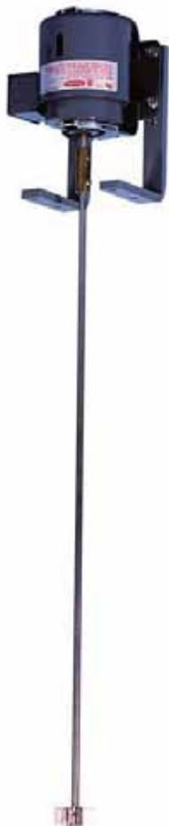
我们提供的小型支架式搅拌机，广泛运用于小型加药系统液体搅拌。两根3/8"厚的不锈钢支架，在四个螺栓的固定下，不需要任何其他辅助设备，就能够使它安全稳定的运行。
