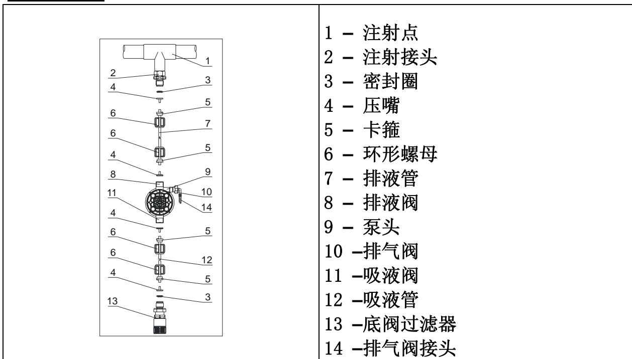
泵工作 800 个小时后，要使用工具再次拧紧可能松动的泵头固定螺栓。
