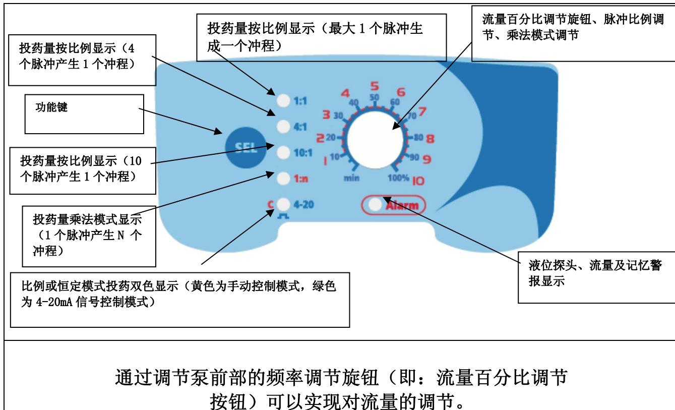
通过调节泵前部的频率调节旋钮（即：流量百分比调节按钮）可以实现对流量的调节。
